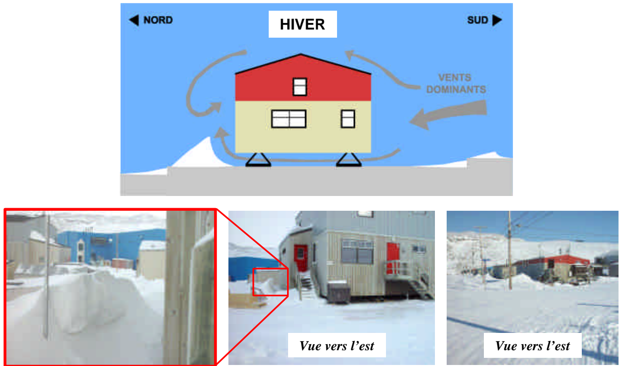
Figure 67 : Accumulation de neige du côté nord des bâtiments.
